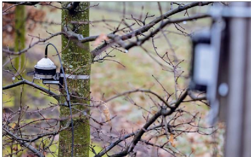
Mit dem Dendrometer wird der Stammumfang der Bäume ermittelt.
